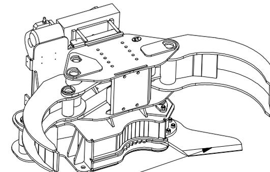
Questo modello di pinza con cesovia ha la caratteristica di avere la lama che entra a scomparsa nel telaio, in questo modo la pinza può essere usata per tagliare ma anche per movimentare e caricare alberi o ramaglie.
